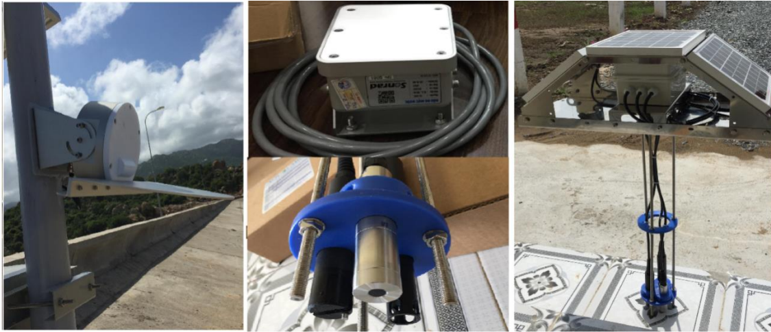
Hình 4: Các dạng đầu đo lưu lượng, mực nước, nhiệt độ
